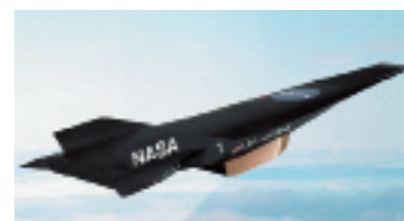
Le X-43A, le «scramjet» de la NASA pouvant voler à près de Mach10
